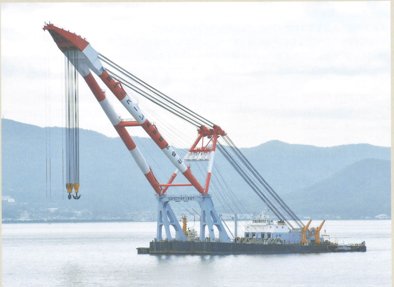
重い物を吊り上げるクレーン船は平らたい船体形状をしているため、メタセンタが高くなり、非常に大きな復原性があります。
