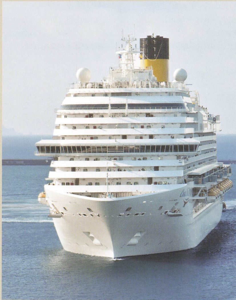
最近の大型クルーズ客船は、たいへん背が高くてトップヘビーのように見えますが、幅が広くて喫水の浅い平たい船体になっているためメタセンタが高く、大きな復原力をもっています。
