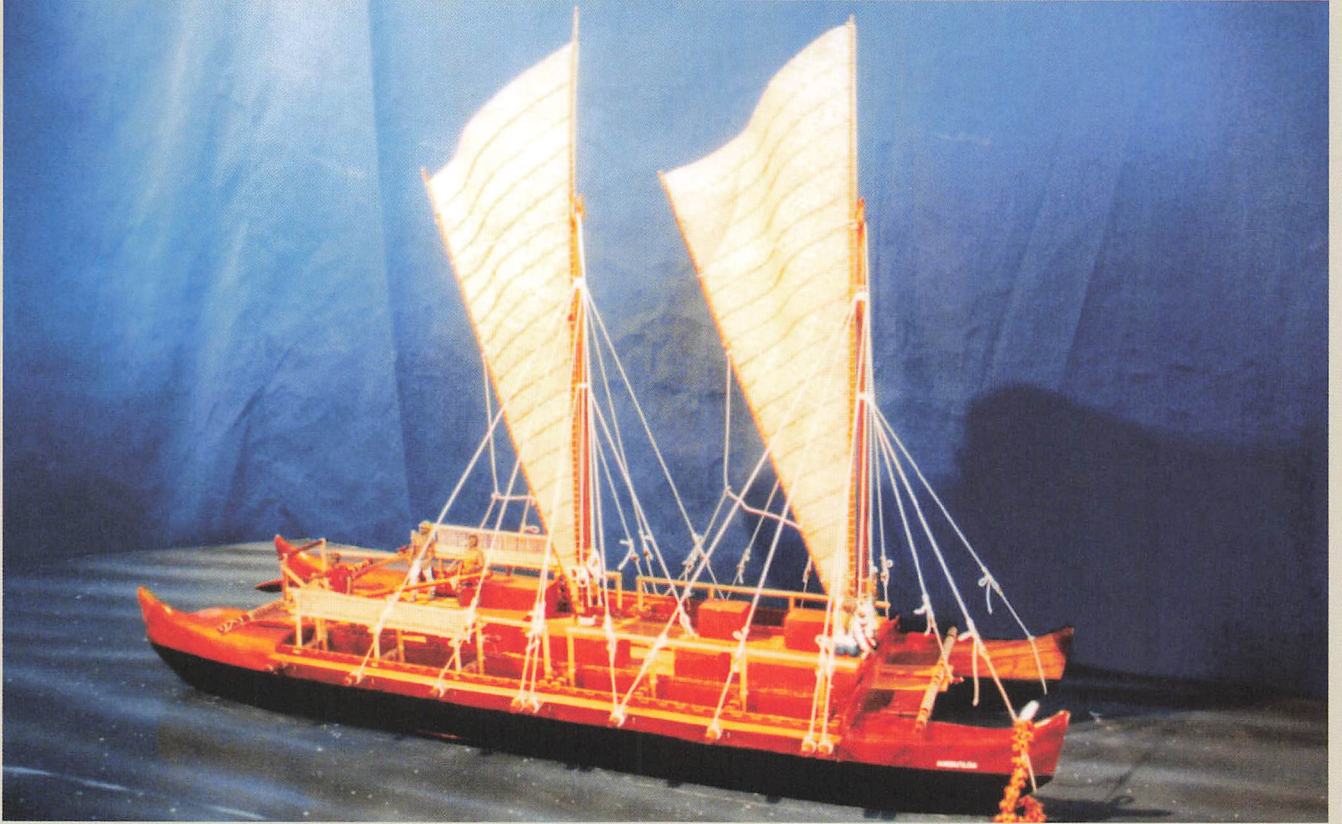
細い長い2つの船体を平行に並べたカタマラン(双胴)は、高い高速性と復原性を同時に得て、古くからミクロネシアの島々の交易に使われました。(ハワイ海事博物館)
