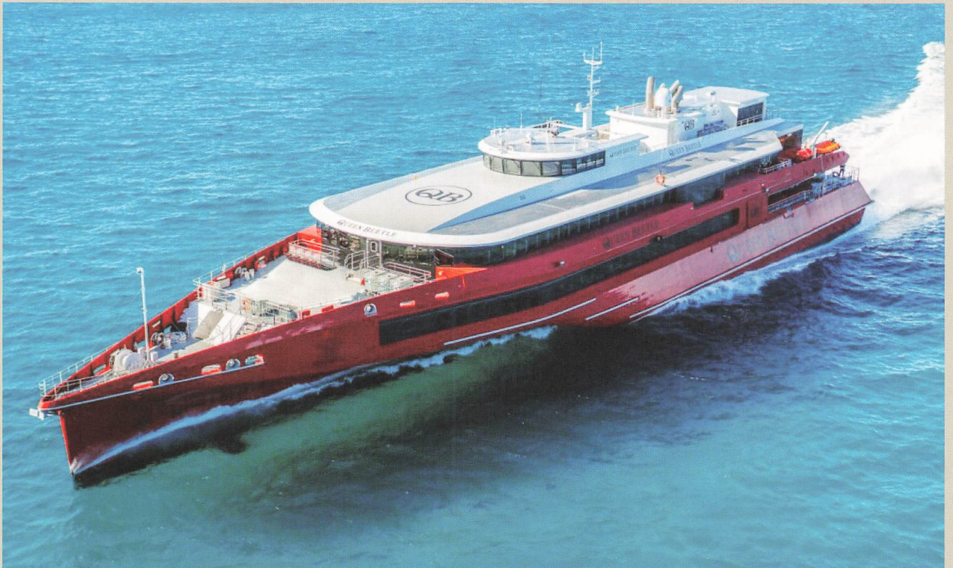
博多と釜山を結ぶ航路に就航するトリマラン型(3胴)の高速客船「クイーンビートル」は復原力と高速性、そして乗り心地も追及した結果として生まれました。(オースタルシップス提供)
